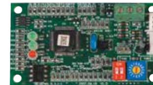
Плата управления сетевая (сетевой модуль) предназначена для подключения фанкойлов в единую сеть с пультом управления LZ-UPW7 или к контроллеру LZ-ModBus3.
