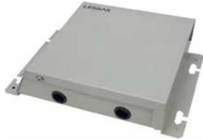
Блок управления (система группового управления) предназначен для организации управления работой фанкойлов с проводного пульта управления LZ-FMPW2, также необходим для подключения фанкойлов к системе централизованного управления с центрального пульта LZ-UPW7. Блок управления LZ-FMM22 имеет встроенный шлюз для подключения фанкойлов к системе BMS по сетевому протоколу Modbus RTU.
