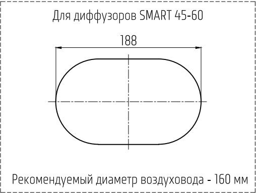
Размеры врезок для подключения гибкого воздуховода:
