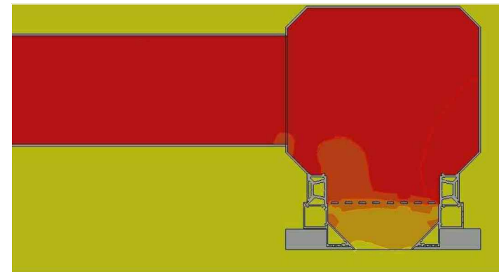
Распределение воздушного потока по длине щели
