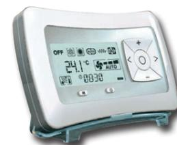
**Пульт дистанционного управления**, состоящий из кнопочной панели и ЖК-дисплея, можно либо крепить на стене, либо устанавливать на специальной настольной подставке. С помощью пульта осуществляется управление всеми параметрами фанкойла в различных конфигурациях. Пульт работает на батарейках. Температура и скорость вентилятора регулируется с помощью двух больших кнопок, обозначенных соответствующими символами.
