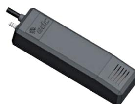
Модель для охлаждения PE-ECM всегда поставляется со встроенным микронасосом (высота нагнетания — 3м, расход воды — 6л/ч). Насос устанавливается в лотке для сбора конденсата, контролирует уровень жидкости и при необходимости сливает конденсат.
