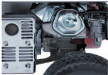
Двигатель Briggs & Stratton 2100 Series™ с технологией клапанного механизма верхнего расположения.
