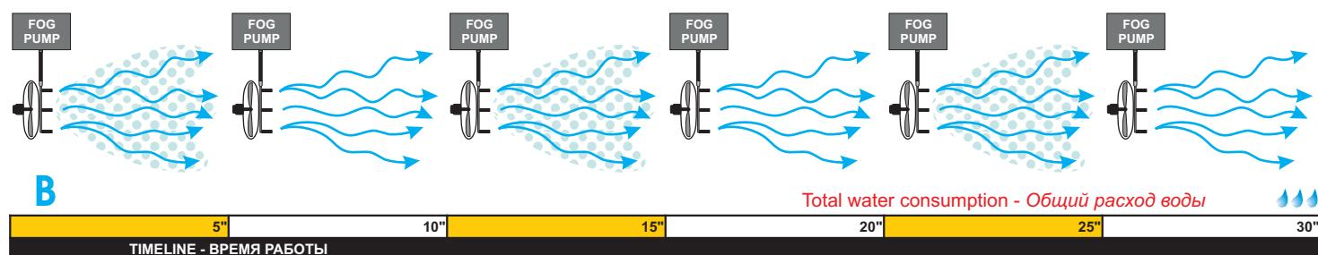
C) "TIME" version pump with **5" ON / 10" OFF** mode setting - Насос с системой "TIME" в режиме 5 с работы / 5 с пауза
