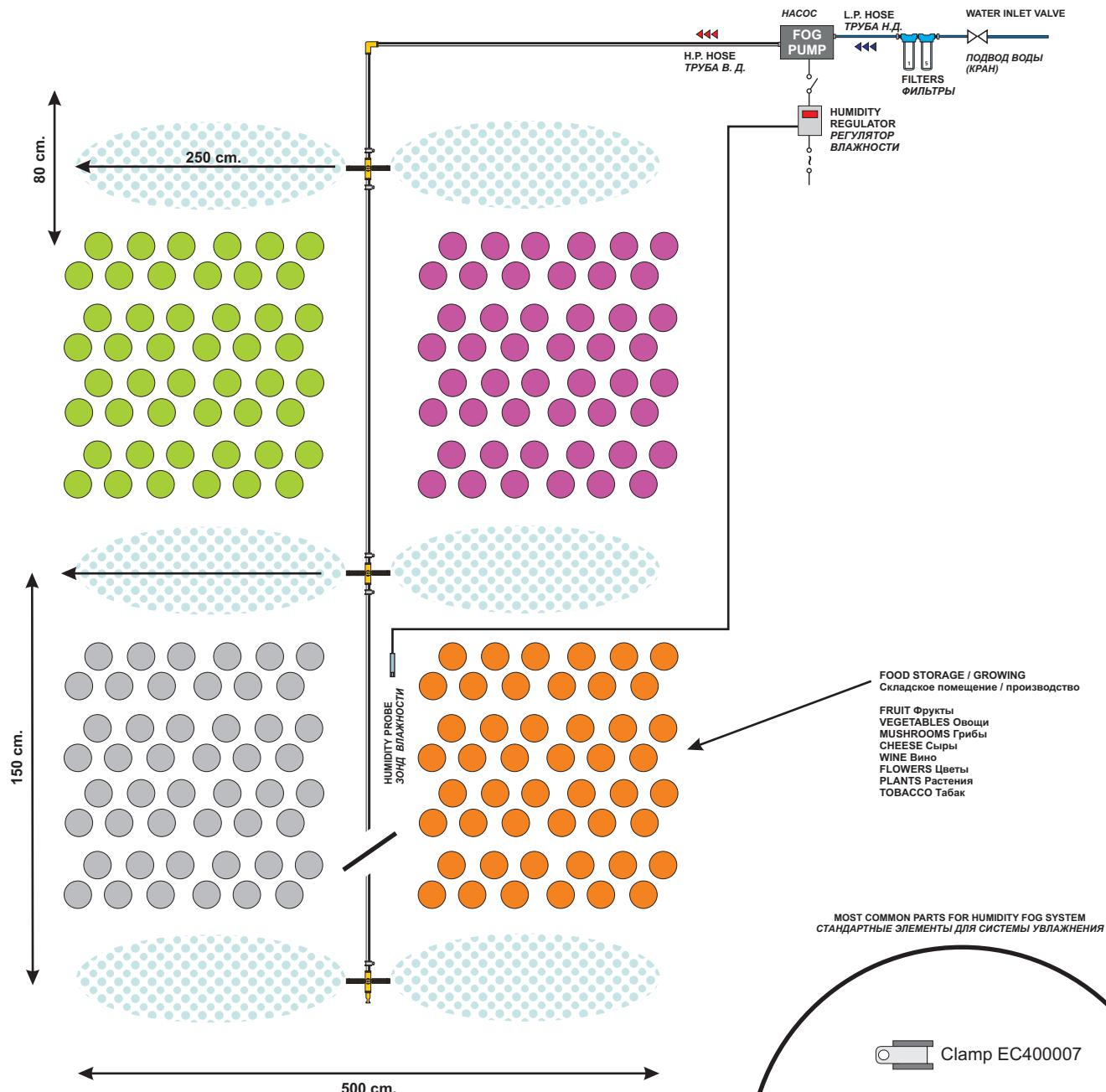
MOST COMMON PARTS FOR HUMIDITY FOG SYSTEM
