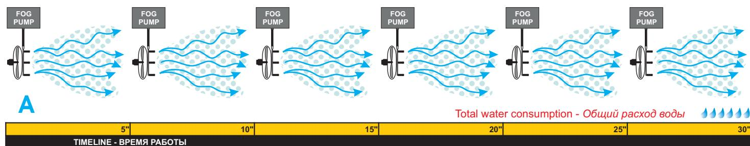
B) "TIME" version pump with **5" ON / 5" OFF** mode setting - Насос с системой "TIME" в режиме 5 с работы / 5 с пауза
