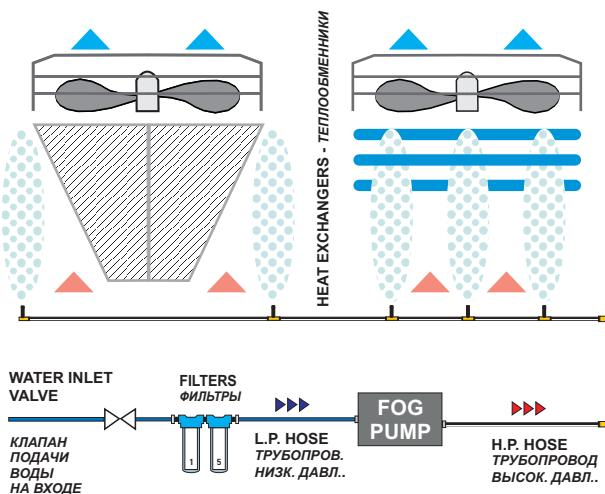
Схема монтажа предварительного охлаждения обменников
