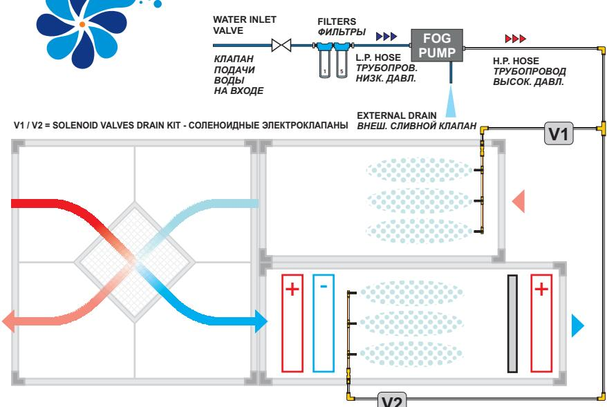
Типичная схема монтажа АНУ: Увлажнение и предварительное охлаждение
