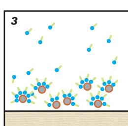
Капли воды захватывают частицы пыли, осаждая их на землю
